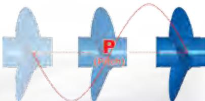
**Hinweis: Ändert man die Steigung des Propellers um ein Zoll, so wird dies die Motordrehzahl um etwa 300-400 U/min verändern.**
